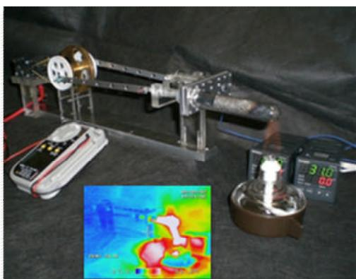
図2 プロトタイプ温度差エンジンとサーモグラフ
