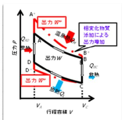
図1 温度差エンジン出力向上原理
