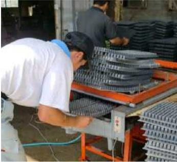
洗浄機にトレーの上面を下に向けて挿入する。
