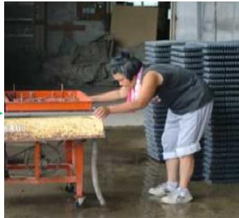
洗浄機内では流水によりトレーが洗浄される。送り出されるトレーを受け取り、次の作業者に渡す。
