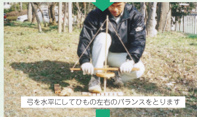
足で火きり臼を固定し先端を切込みの根元におきます
