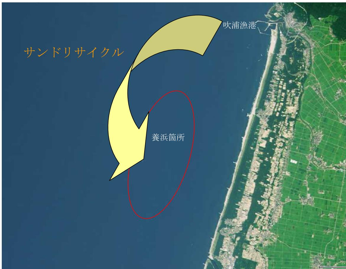
吹浦漁港の浚渫土砂を近傍の比子地区海岸にサンドリサイクルしている。山形県の水産課と河川砂防課が連携し、土砂の投入とモニタリングというように役割を分担し、事業を実施している。
