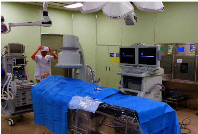
移動型C型アーム血管造影装置の試運転の様子
