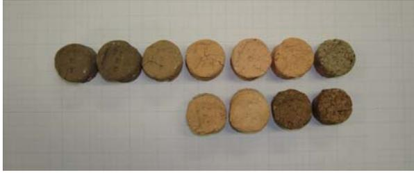
写真23 Dの焼成試料(上段酸化、下段還元)
