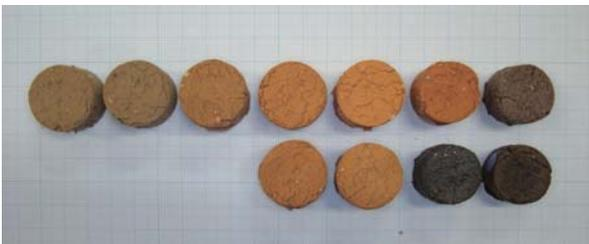
写真21 Bの焼成試料(上段酸化、下段還元)
