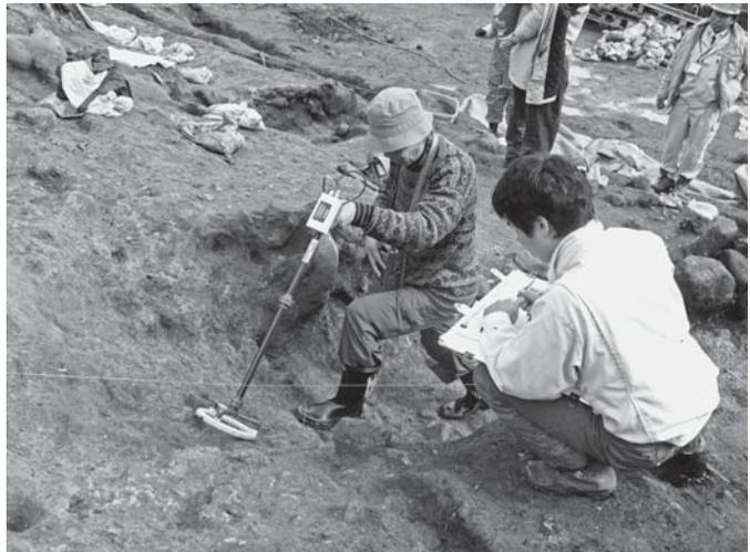
写真16 大型帯磁率測定器による計測
