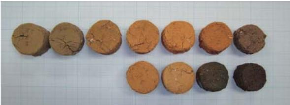
写真20 Aの焼成試料(上段酸化、下段還元)
