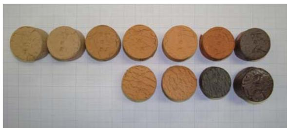
写真22 Cの焼成試料(上段酸化、下段還元)
