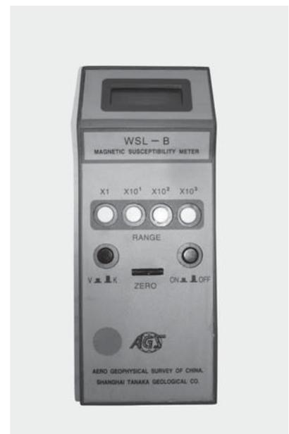
写真13 使用した帯磁率計
