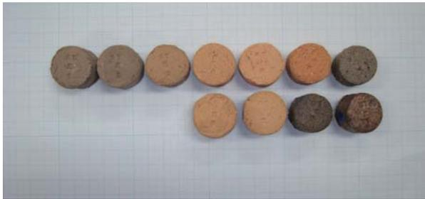
写真24 Eの焼成試料(上段酸化、下段還元)
