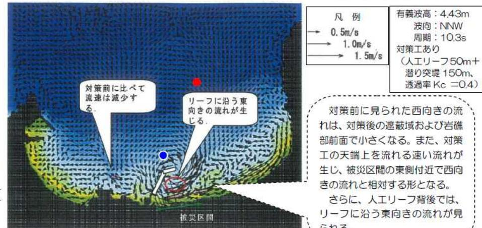
図 25 建設後の海浜流計算結果
