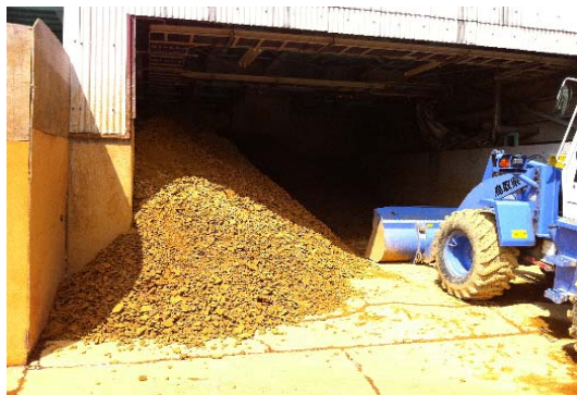
旧岩美鉱山の坑廃水処理において発生する澱物 ※脱水処理して排出される
