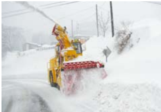
ロータリー除雪車による除雪(2012年2月下蚊屋地内)
