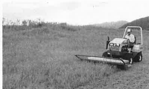
ベントラックによる除草作業
