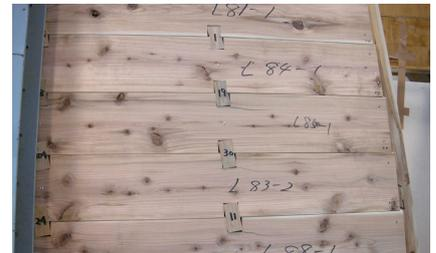
図-2 P<sub>MAX</sub> 時の壁面の状態
