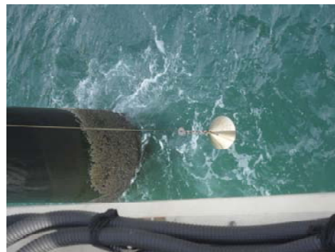
(写真6) サンドトラップの深さの計測装置
