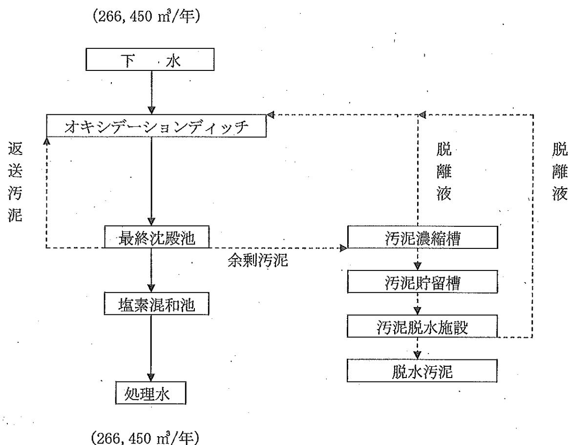
図2 下水処理場の配置図
