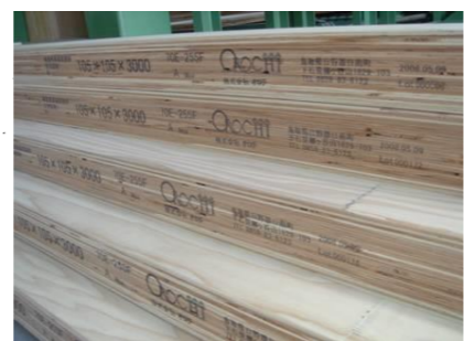
【日野川流域材の活用】 地元のスギを使用したLVL(単板積層材)製造工場が完成。H20.4から操業開始した。(日南町下石見 (株)オロチ)
