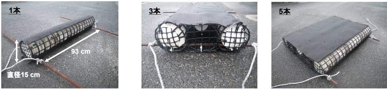
図5. 試作し、本試験で使用した簡易保護育成礁（1，3，5本つづり）。
