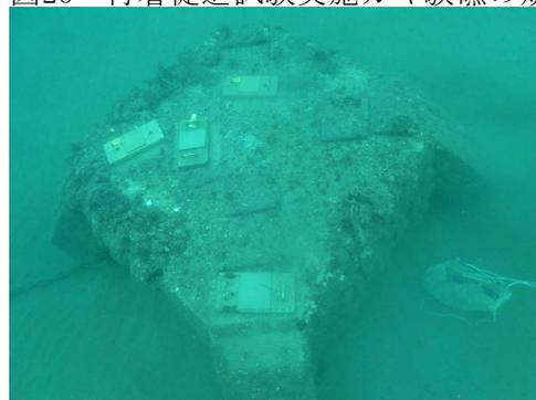
図28 試験礁に試験付着板を設置した状況
