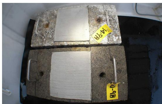
図27 付着板（25cm×50cm×厚さ5cm）の一部に厚さ1cm（18cm×21cm四方）のセメントを塗布。
