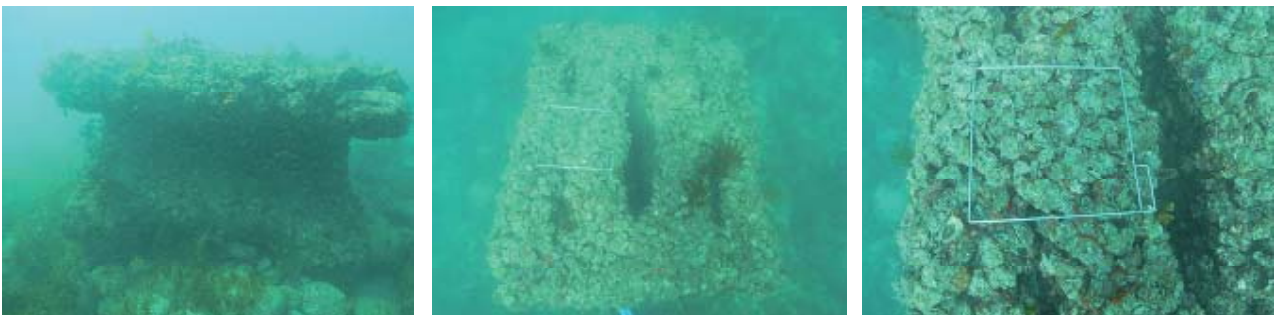
図7 定点1西端側π型礁-⑤(左:外観, 中央:天端, 右:カキ付着)
