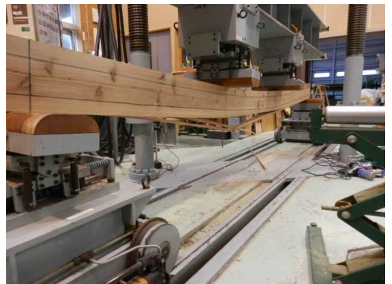
図 1 曲げ強度試験の状況
